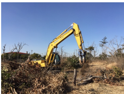
伐採した木々を重機で破砕し、チップ化します
