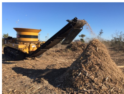
伐採した木々を重機で破砕し、チップ化します
